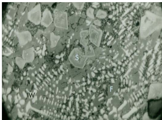
Fig. 7. Tap slag: F=fayalite; W=wustite; S=spinel Fe.Al (x165)
